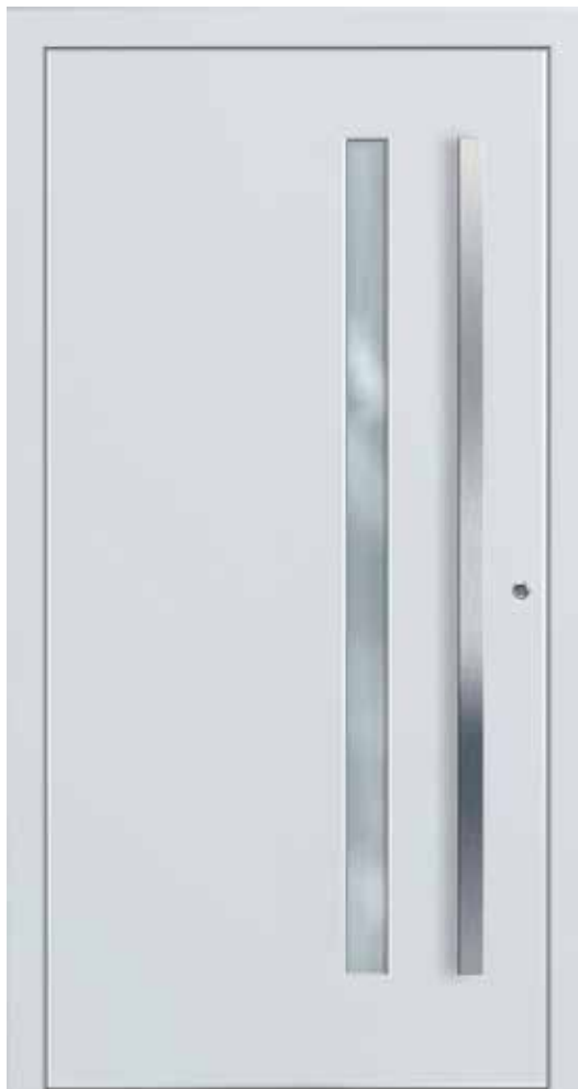
T07 Farbe Rahmen/Flügel RAL 9016 FS Farbe Füllung außen/innen RAL 9016 FS Glas 4/18/4 Satinato -18/4 Ug=0,5 TGI schwarz Griff TF 160 + Rundrosette AJM Inox Matt
