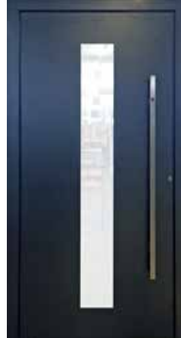
T14 Farbe Rahmen/Flügel Antigue Silver (Rahmenstärke 95 mm) Farbe Füllung außen/innen Antigue Silver Glas 4/18/4 SSS Grey -18/4 Ug=0,5 TGI schwarz Griff TD 5 (mit Türspion) + Rundrosette AJM Inox Matt
