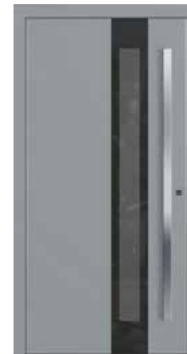
T22 Farbe Rahmen/Flügel RAL 9006 FS Farbe Füllung außen/innen RAL 9006 FS Glas ESG 6/20/4 Satinato - 20/4 mit emailiertem schwarzen Rand Ug=1,1 Griff TC160 + Rundrosette AJM Inox Matt
