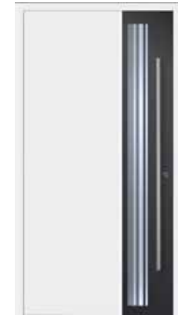
T34 Farbe Rahmen/Flügel RAL 9016 matt Farbe Füllung außen/innen RAL 9016 matt Glas ESG 6/20/4 Satinato - 20/4 mit emailiertem schwarzen Rand nach dem Muster Ug=1,1 Griff TR160/90° + Rundrosette AJM Inox Matt
