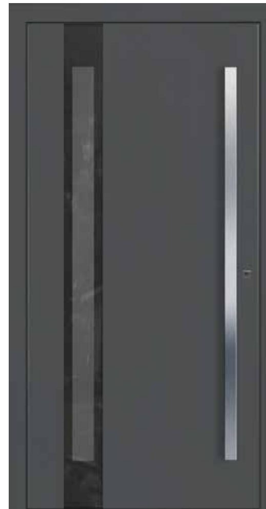
T33 Farbe Rahmen/Flügel RAL 7016 matt Farbe Füllung außen/innen RAL 7016 matt Glas ESG 6/20/4 Satinato - 20/4 mit emailiertem schwarzen Rand Ug=1,1 Griff TC 160 + Rundrosette AJM Inox Matt
