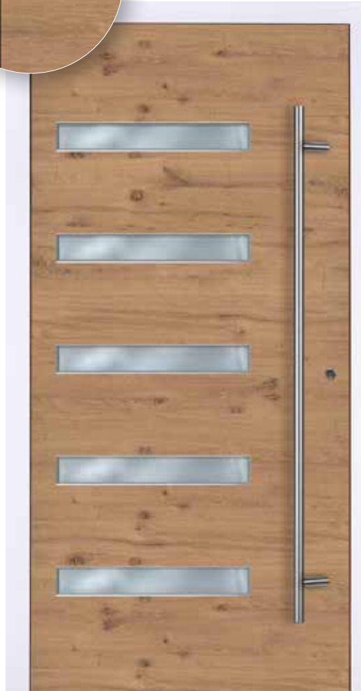
TL6 ALU-Rahmen, Holz-Füllung Farbe Rahmen außen/innen RAL 9016 FS Flügel außen/innen Eiche astig Glas 4/18/4 Satinato - 18/4 Ug=0,5 Griff TR 160/45° + Rundrosette AJM Inox Matt
